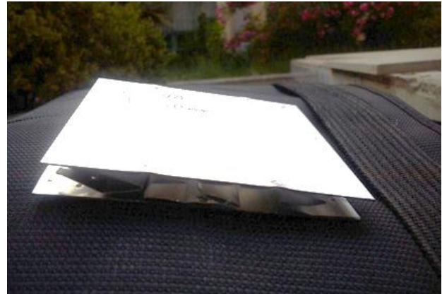
شکل 9 نمونه سوم پس از تست ضربه
