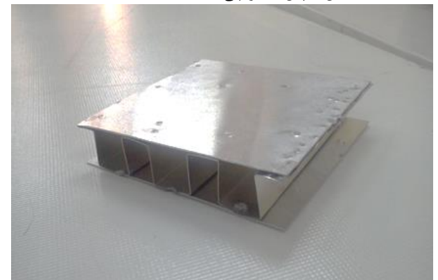
شکل 4 پنل ساندویچی ساخته شده با هسته 3
