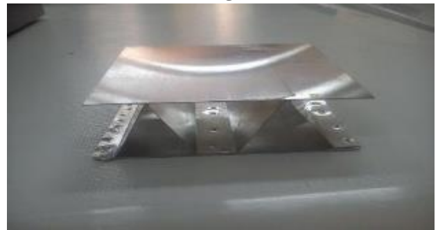
شکل 3 پنل ساندویچی ساخته شده با هسته 2
