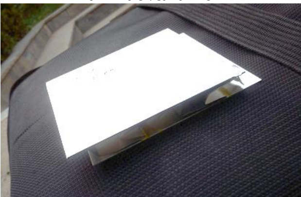
شکل 8 نمونه دوم پس از تست ضربه
