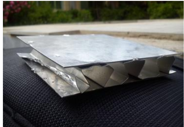
شکل 10 نمونه سوم پس از تست ضربه
