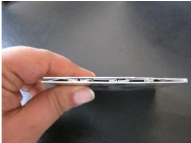
شکل 7 نمونه اول پس از تست ضربه
