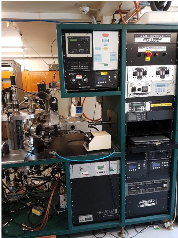
شکل ۱. نمای دستگاه لایه نشانی هایپیمز
