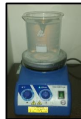
شکل ۱: قرارگیری بشر حاوی نانوذرات کروی سیلیکا و آب دیونیزه روی همزن
